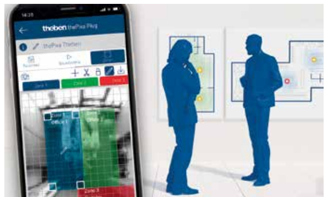
Der erfasste Bereich kann in verschiedene Zonen gegliedert werden. Auch das Einrichten von Sperrzonen, in welchen erfasste Bewegungen keine Aktionen auslösen, ist möglich.
