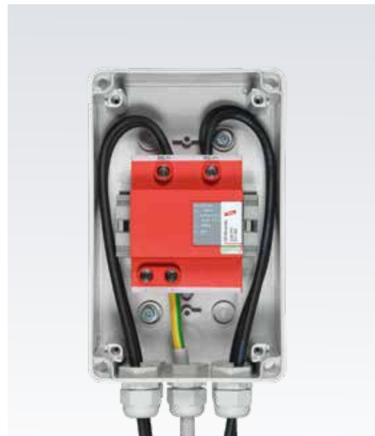
Bild 3: Blitzstromtragfähiges SPD Typ 1 zum Schutz der DC-Seite des Wechselrichters bei nicht eingehaltenem Trennungsabstand zwischen Blitzschutzanlage und PV-System
