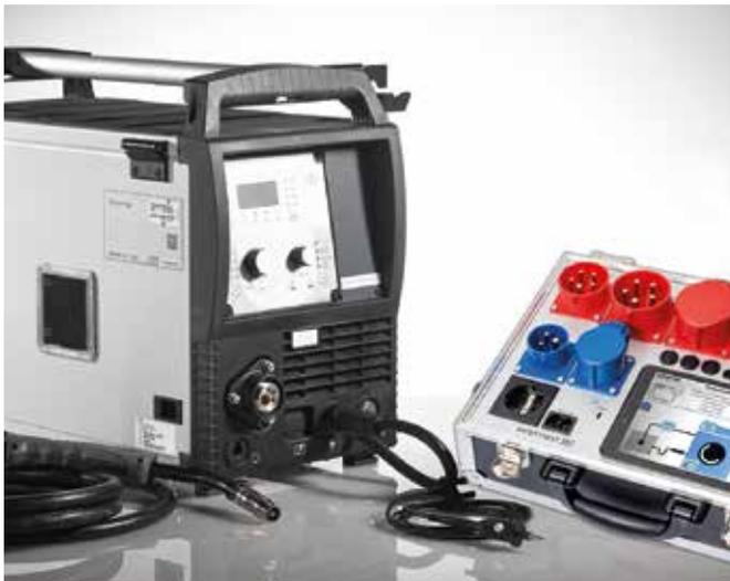
Prüfung von Schweißgeräten gem VDE 0544-4 (DIN EN 60974-4) mit dem SAFETYTEST 3RT über Test Master App
