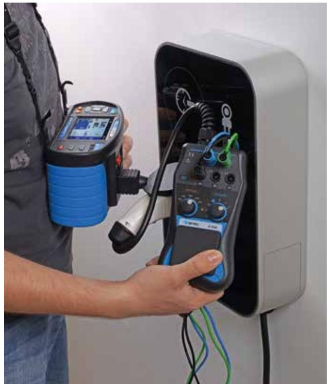
mit. Durch den Metrel A 1532 XA kann man diese Erprobung ganz einfach über die Schalterstellung simulieren. Außerdem bietet dieser Adapter die Möglichkeit, einige Prüfungen in Kombination mit dem Euro-test XD oder auch anderen Messgeräten durchzuführen.
