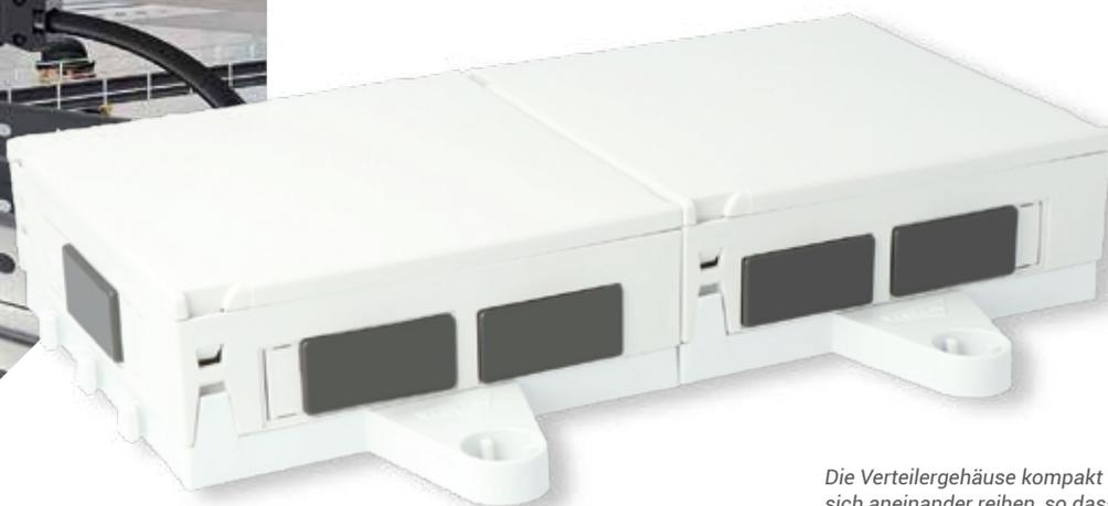
Die Verteilergehäuse kompakt Multi-PD lassen sich aneinander reihen, so dass auch größere Verteileinheiten damit errichtet werden können. Seitlich am Gehäuse angebrachte Befestigungslaschen ermöglichen eine Aufputzmontage oder Fixierung am Boden.
