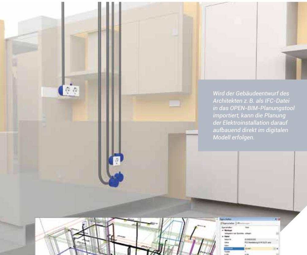
Wird der Gebäudeentwurf des Architekten z. B. als IFC-Datei in das OPEN-BIM-Planungstool importiert, kann die Planung der Elektroinstallation darauf aufbauend direkt im digitalen Modell erfolgen.
