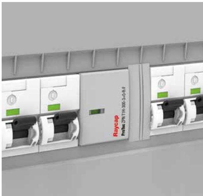
Der kompakte ProTec ZPN findet zusammen mit der Einspeiseklemme ProAcc ZP-TB in jeder noch so engen Hauptverteilung Platz. Dank seines anpassbaren und manipulatorsicheren Abdeckstreifens haben nur autorisierte Elektriker Zugriff auf den Vorzählerbereich um SPD und Zubehör.
