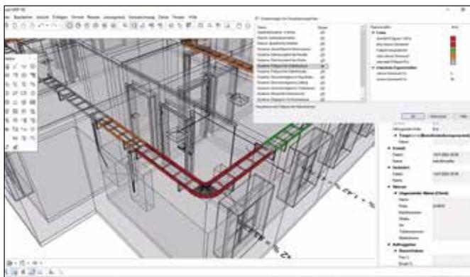
Bild 2: In DDScad 18 lässt sich der Füllungsgrad von Verlegesystemen mithilfe eines Visualisierungsfilters farblich im Modell veranschaulichen.
